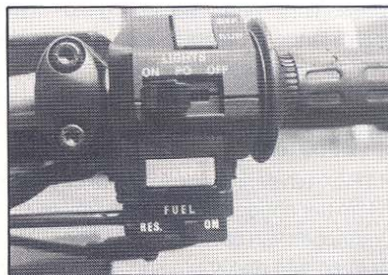
De bedieningsknoppen zijn groot en goed geplaatst. Onder de startknop de schakelaar voor de benzinekraan.
